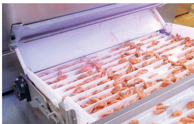
Udløbshøjden er 435 mm, hvilket giver god plads til rengøring af gulv.
